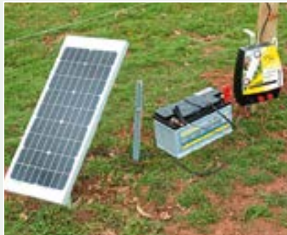
Akkubetriebene Weidezaungeräte sind so leistungsfähig wie Netzgeräte. Ein Solarpaneel reduziert den Aufwand für das Aufladen des Akkus.
